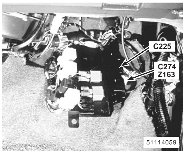
136. detrás del lado derecho del salpicadero Z163 Unidad de alarma antirrobo C225 (16-B) C274 (6-W)
